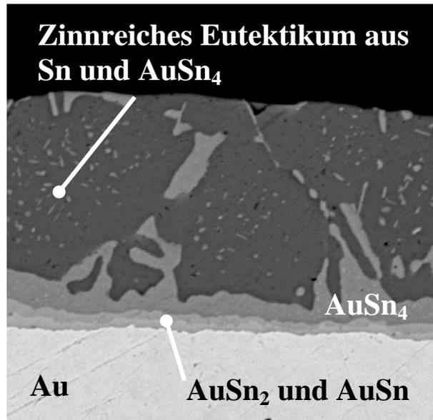
a) Au/Sn-Bump aufgeheizt bis 217 °C. SEM-Aufnahme wenige Tage nach Versuch
