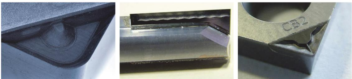
**Abbildung 19:** Beispiele gelaserner Spanbrechergeometrien: links - gelaserte Spanleitstufe ; mittig - Schaftfräser mit Spanleitstufe; rechts - WSP mit gelaserner Spanleitstufe (**Becker 2009**)
