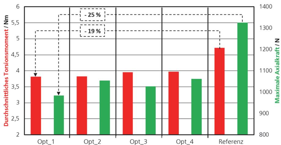
**Abbildung 105:** Einsatzverhalten der Werkzeuge in Mittelung über 900 Bohrungen
