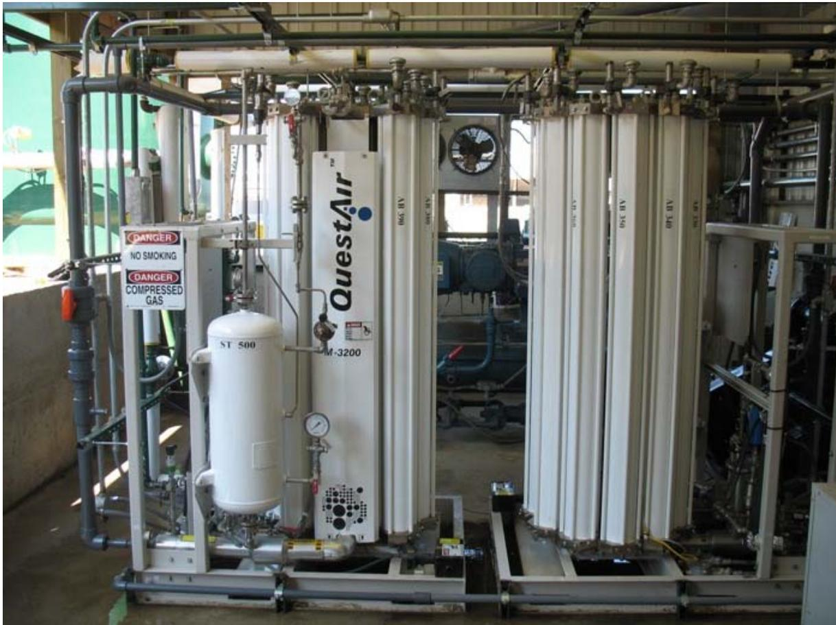
Abbildung 4-9: PSA-Anlage Typ QuestAir™ M-3200 (Foto: QuestAir Technologies Inc.)
