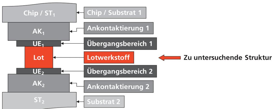
Abbildung 4.1: Kategorisierung von Teststrukturen nach dem zu untersuchenden Lotwerkstoff (Lot), den Übergangsbereichen (UE<sub>1,2</sub>), Ankontaktierungen (AK<sub>1,2</sub>) und dem Chip bzw. Substrat (ST<sub>1,2</sub>)
