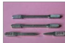
Tensile Specimen (here: Solder)
